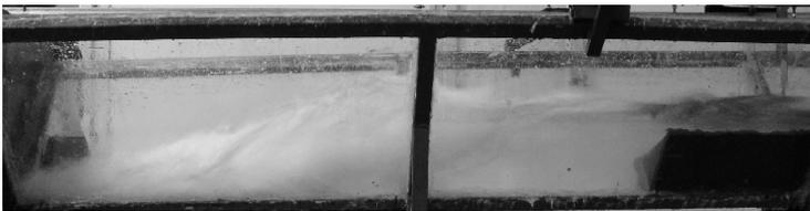
**Figure 2** : Photographie d'un ressaut hydraulique de type A forcé par marche positive.
