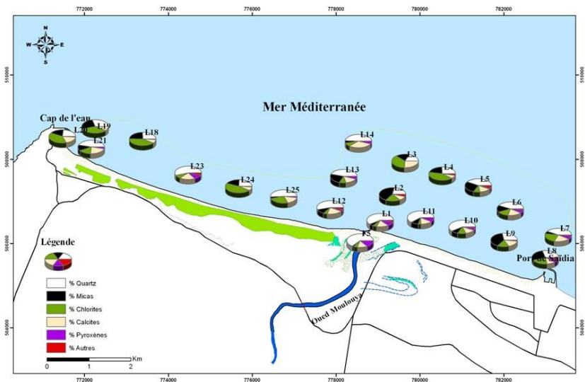
Figure 12 : Carte de la répartition spatiale des principaux minéraux composant dans les sédiments superficiels de la plage sous-marine de Saïdia.
