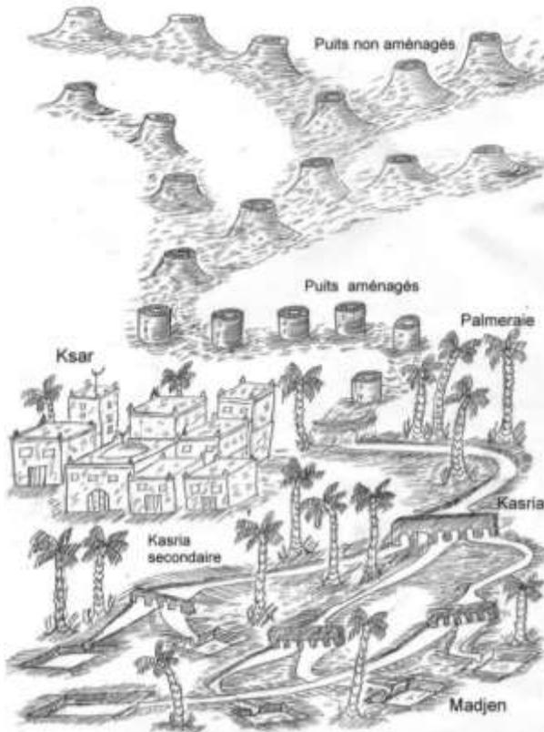
Figure 4 : Schéma simplifié du système foggara (Remini, 2017)
