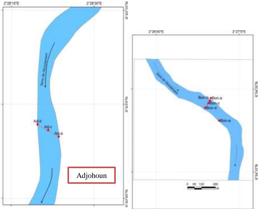
Figure 2 : Positionnement des transects de mesures des paramètres hydrodynamiques à Bonou et d'Adjohoun
