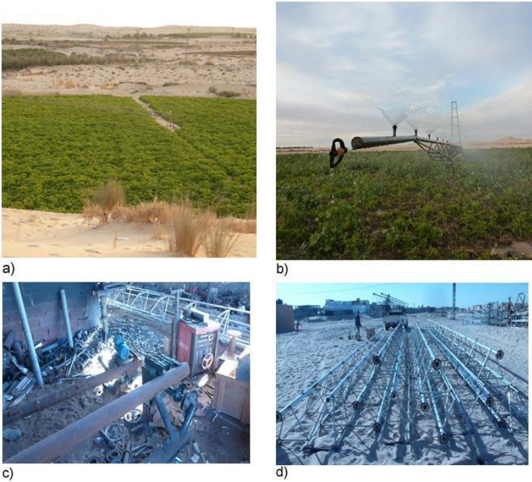
Figure 13 : Les rampes pivotantes réalisées localement par les Soufis (Auteurs, 2016)
