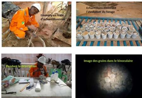
Figure 7 : Echantillonnage et description des cuttings des formations géologiques traversées (Kashala, 2018)
