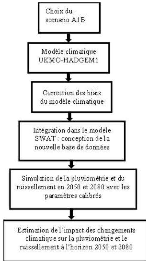
Figure 7 : Principe de l'étude d'impact des changements climatiques dans un bassin versant à l'aide de SWAT
