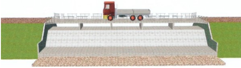
Figure 9 : Perspective de l'aval de l'évacuateur de crue
