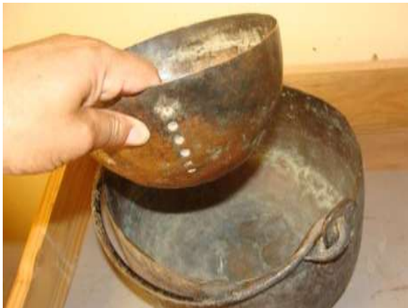
Figure 32 : Principe de mesure par la montre à eau (Photo. Remini, 2014)
