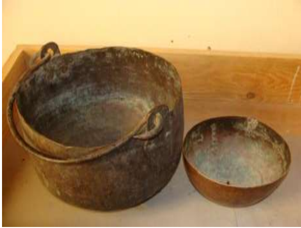
Figure 31 : Tassa ; la montre à eau utilisée dans l'oasis de Moghrar pour la mesure des parts d'eau des agriculteurs (photo. Remini, 2014)
