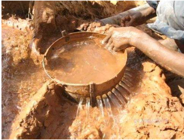
Figure 29 : Opération de jaugeage d'une foggara dans une oasis de Tidikelt
