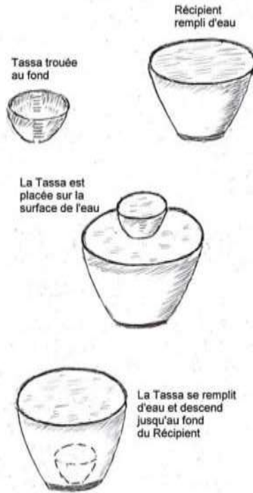
Figure 33 : Schéma des étapes de mesures des parts d'eau d'une foggara Horaire par la montre à eau (Schéma Remini, 2019)
