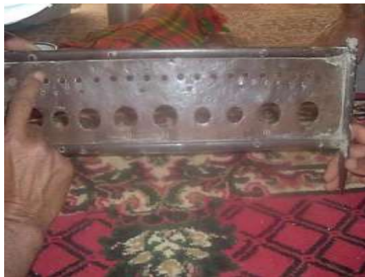
Figure 24 : Louh, utilisé dans les oasis de Gourara (Remini, 2008)
