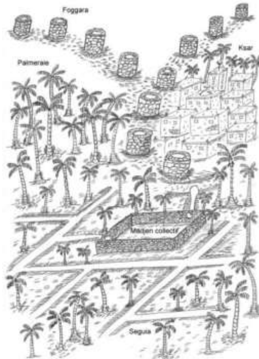
Figure 18 : Schéma d'un réseau ramifié d'une foggara horaire (Schéma Remini, 2017)
