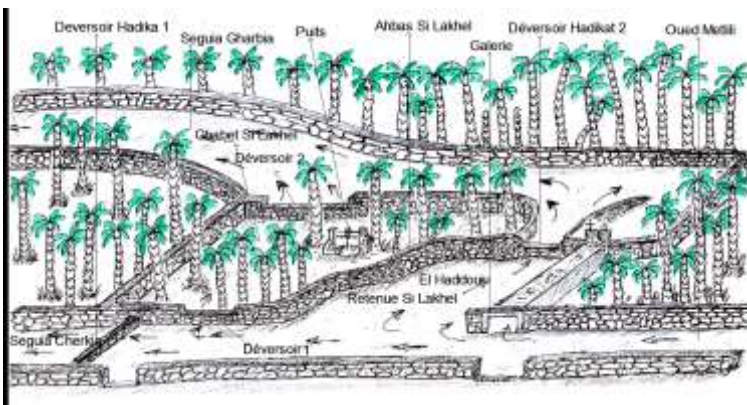
Figure 39 : Schéma général du le lieu de partage des eaux de crues de Metlili (Schéma Remini, 2019)
