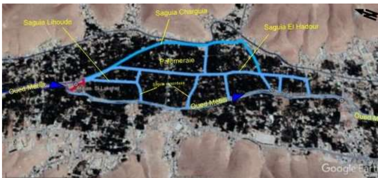
Figure 56 : Système de partage des eaux brutes des crues dans la palmeraie de Metlili (Google Earth, Ouled Belkhir, 2019)
