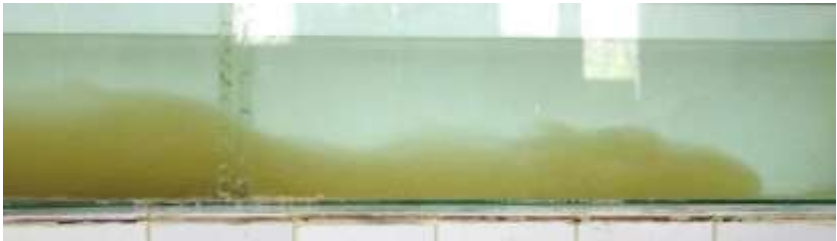
Figure 15 : Courant de turbidité au fond d'un canal avec une faible concentration en particules fines (Photo. Remini, 2017)
