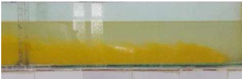
Figure 11 : Courant de densité au fond d'un canal avec une forte concentration en particules fines (Photo. Remini, 2017)
