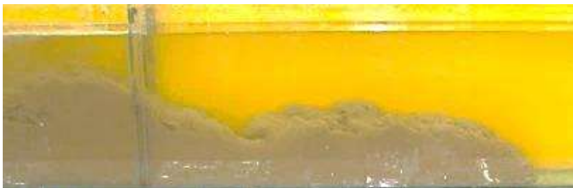
Figure 12 : Courant de densité formé avec la vase du barrage de Beni Haroun (Photo. Remini, 2016)
