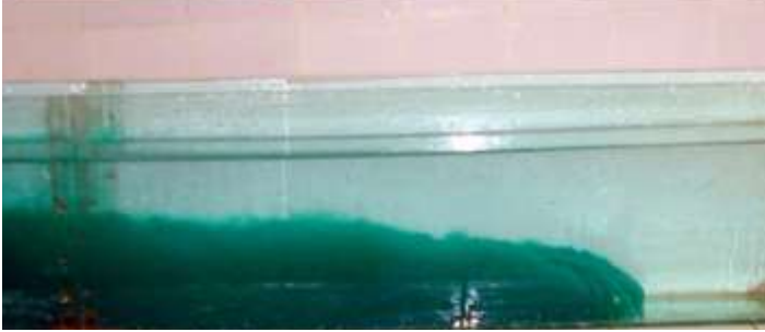
Figure 34 : Propagation d'un courant de densité dans un canal (Photo. Remini, 2014)
