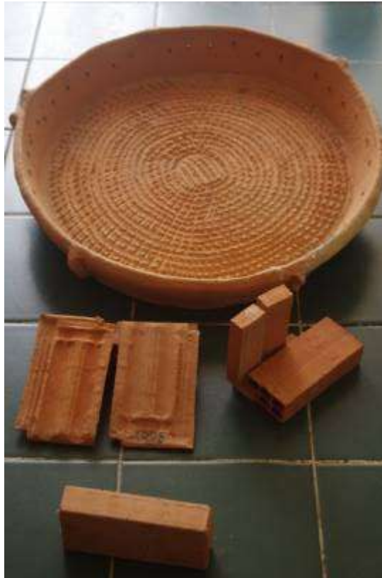
Figure 28 : Produits finis obtenus par la boue de dévasement par la vanne de fond du barrage de Sidi M'hamed Ben Aouda (Photo. Remini, 2016)
